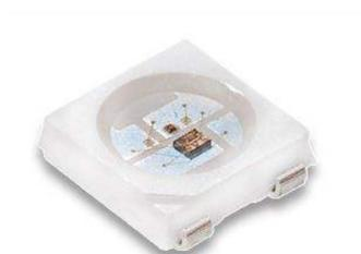
WS2812E 是一个集控制电路与发光电路于一体的智能外控 LED 光源。其外型与一个 5050LED 灯珠相同，每个元件即为一个像素点。像素点内部包含了智能数字接口数据锁存信号整形放大驱动电路，还包含有高精度的内部振荡器和可编程定电流控制部分，有效保证了像素点光的颜色高度一致。数据协议采用单线归零码的通讯方式，像素点在上电复位以后，DIN 端接受从控制器传输过来的数据，首先送过来的 24bit 数据被第一个像素点提取后，送到像素点内部的数据锁存器，剩余的数据经过内部整形处理电路整形放大后通过 DO 端口开始转发输出给下一个级联的像素点，每经过一个像素点的传输，信号减少 24bit。像素点采用自动整形转发技术，使得该像素点的级联个数不受信号传送的限制，仅受限信号传输速度要求。
