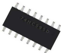
74HC595 是一个 8 位串行输入、并行输出的位移缓存器：并行输出为三态输出。在 SCK 的上升沿，串行数据由 SDL 输入到内部的 8 位位移缓存器，并由 Q7' 输出，而并行输出则是在 LCK 的上升沿将在 8 位位移缓存器的数据存入到 8 位并行输出缓存器。当串行数据输入端 OE 的控制信号为低使能时，并行输出端的输出值等于并行输出缓存器所存储的值。
