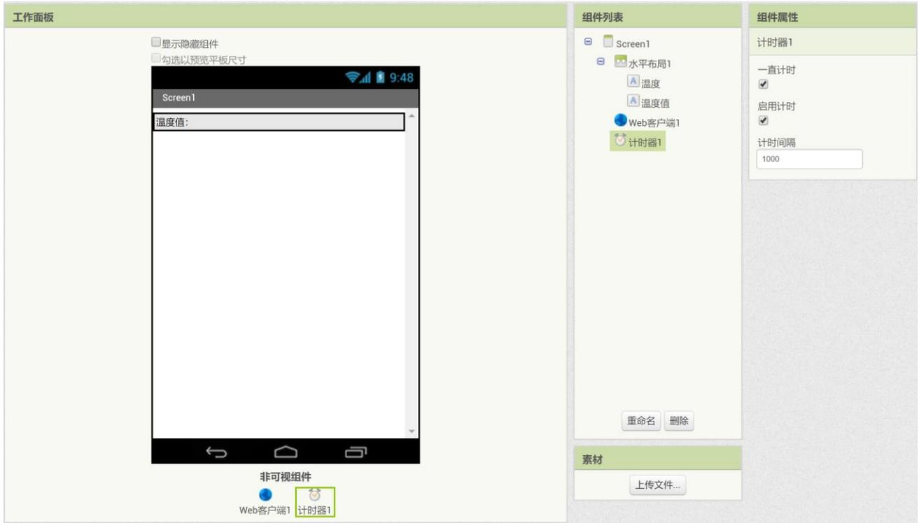
添加两个标签，一个用于显示“温度值”栏目，一个用于显示温度数值；添加一个计时器，用于定时更新数值；添加一个 Web 客户端。
